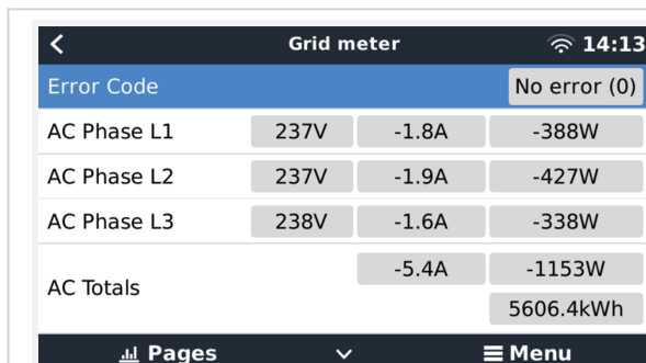
Detaillierte Übersichtsseite eines dreiphasigen Netzzählers
